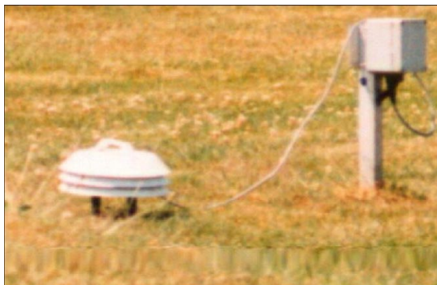
figuur 3: schotelhut met stralingsafscherming voor 10 cm temperatuur
